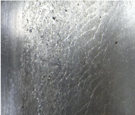
Abbildung 1: Feine thermische Risse
