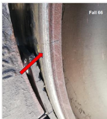
Abbildung 5: Beispiel eines Eckrisses
