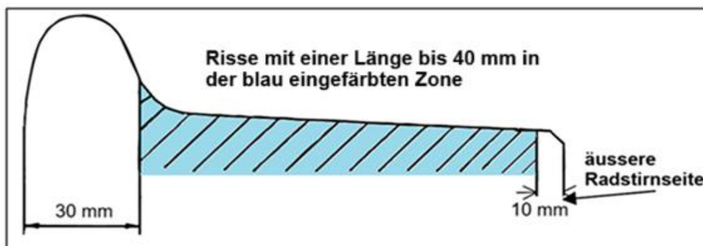
Abbildung 3: Ausbreitung des thermischen Risses der Klasse 1 (Risslänge \leq 40 mm)
