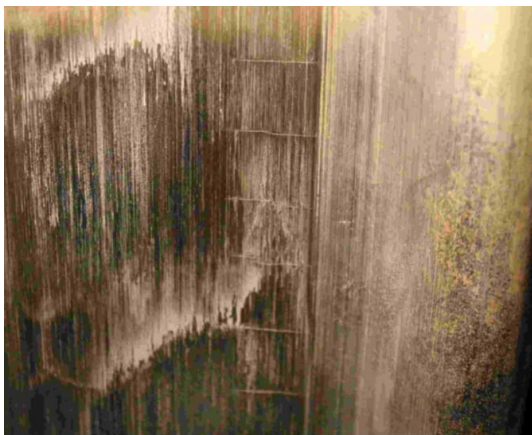
Beispiel 2 eines thermischen Risses
